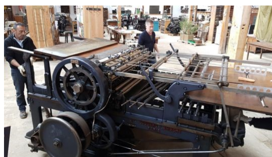
Machine Lambert, pour l'impression des affiches avec des caractères en bois
